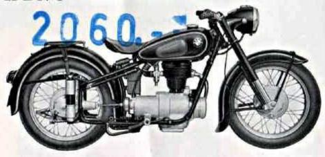
Leistungsstarker Einzylinder-Motor. Verlängerte Ansaugleitung für gleichmäßige kühle Luftstromführung. Vierganggetriebe, Fußschaltung. Besonders weich wirkende Kupplung. Teleskopgabel mit hydraulischer Stoßdämpfung.
