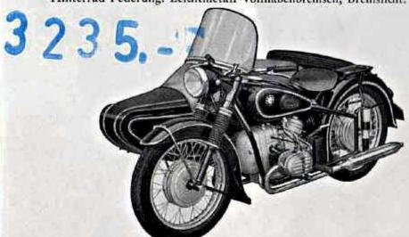
Seitenwagen-Schwingachse und Boot mit weicher Gummifederung, Oldruckbremse für Seitenwagenrad. Auch in Solo-Ausführung lieferbar.
