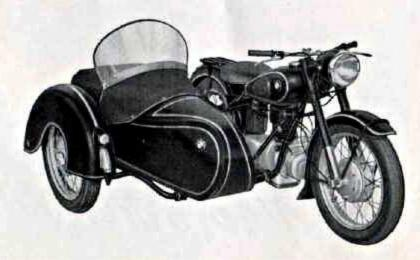
D 25/3 mit BMW Seitenwagen "Standard". Schwingachse und Boot mit weicher Gummifederung. Vierpunkt-Kugelanschluß. Für drei Personen zugelassen.
