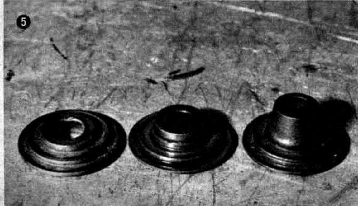
Bei BMW werden eine große Anzahl verschiedener Ventilfederteller für die diversen Modelle hergestellt, für unsere Zwecke hat sich der mittlere wegen seines relativ geringen Gewichtes als günstig erwiesen.
