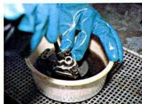
Antriebswelle einstecken, in Kaltreiniger tauchen und drehen – pumpt sie oder nicht?
