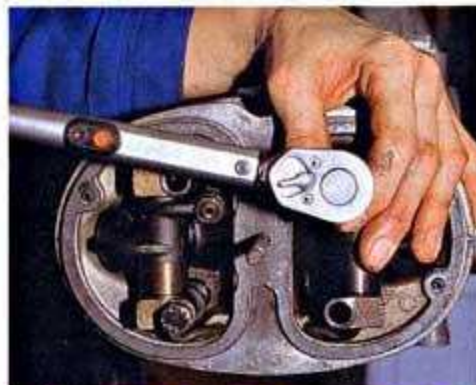
Die vier Zylinderkopfschrauben werden über Kreuz gelöst. Sie halten die Kipphebelböcke
