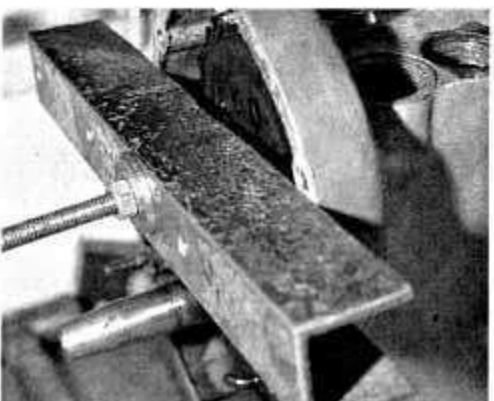
...des Eigenbau-Abziehers gleitet die Welle samt beiden Lagern leichtgängig aus dem Gehäuse
