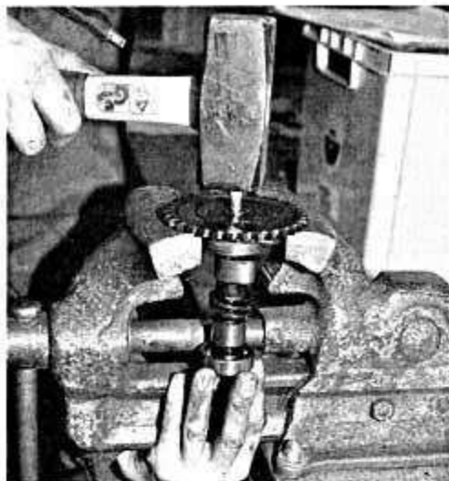
...muss das Ritzel mit einem Schlag auf eine in die Welle eingedrehte Schraube entfernt werden
