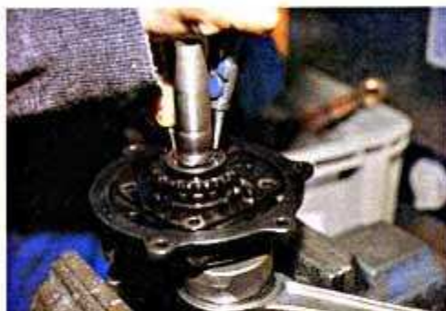
Vor dem Abziehen des Steuerkettenritzels den Segerring nicht vergessen!
