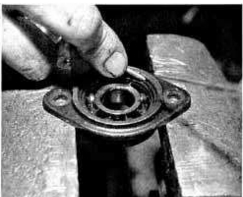
Vor dem Austreiben des Lagers aus dem Schild nicht den Sicherungsring vergessen. Zuvor...
