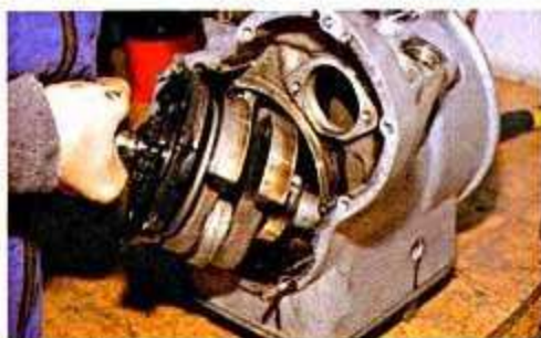
Nun kann die Welle nach Schlangentänzer- manier aus dem Block herausgewunden werden
