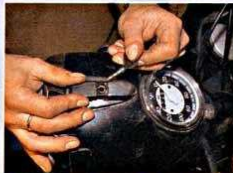
Zündaussetzers Ursprung: Fast immer sind die Kugeln im Zündschloss abgenutzt
