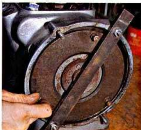
Ein Flachstahlstück sichert die Kupplung gegen Herausfallen nach Lösen der Halteschrauben
