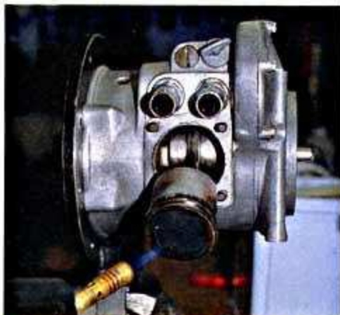
Zum leichteren Austreiben des Bolzens wird der Kolbenboden mit der Lötlampe erhitzt
