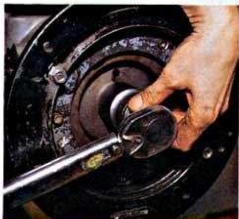
Zum Lösen der Schwungscheibenmutter muss das Schwungrad blockiert werden
