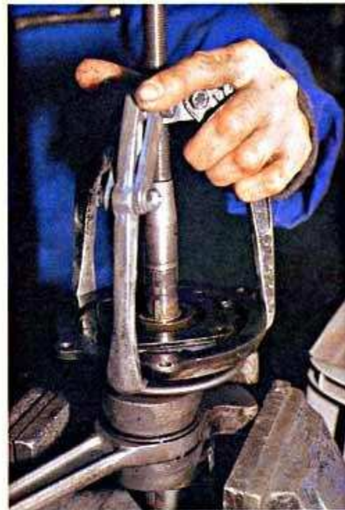
...Dreiarms-Abzieher, der zum Abnehmen des vorderen Lagerschildes benutzt wird
