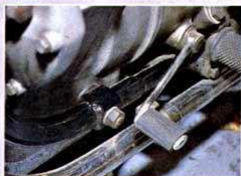
Die Schalen der Motorhalterungen lösen sich mitunter von den Rahmenrohren
