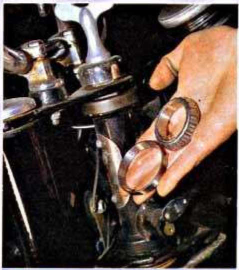
Für defekte Lenkkopflager empfiehlt sich unbedingt moderner Kegelrollen-Ersatz
