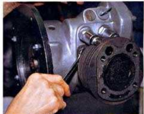
Für die Zylinderfußmutter muss man sich einen 14er Ringschlüssel zurechtshleifen
