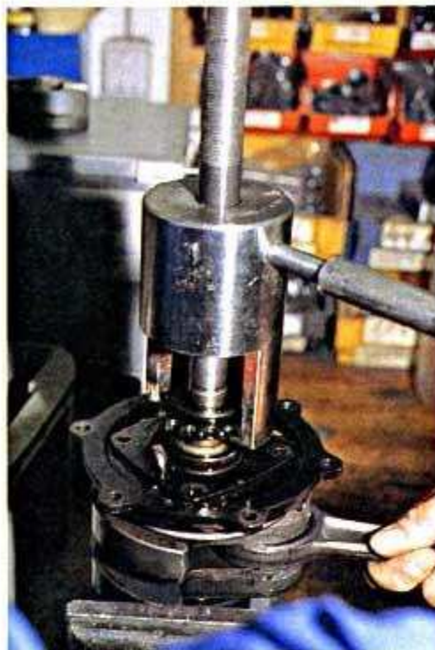
Ein Spezialabzieher für das extrem fest sitzende Ritzel ist sinnvoll, es geht aber auch mit dem...
