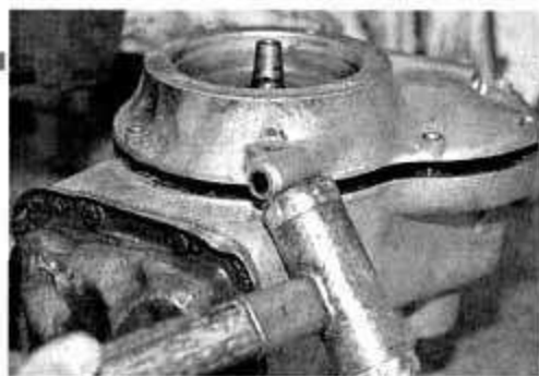
...und dann mit leichten Schlägen unter Motorentlüftungsrohr und -halterung gelockert
