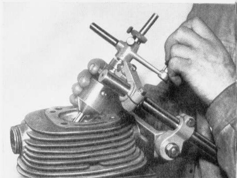
Al trabajar los asientos de las válvulas con el aparato «Hunger» y los machos de las válvulas con una rectificadora, ya no es preciso someterles a un tratamiento final con pasta para esmerilar. Sin embargo, si se recomienda comprobar el cierre hermético de las válvulas echando gasolina en la cámara valvular. Para efectuar un esmerilado de adaptación se utilizan los sujetaválvulas Matra 368 o 540.
