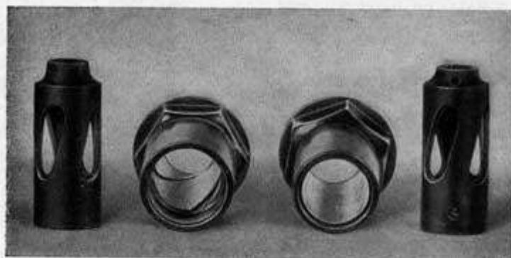
Stößel und Führungen sind an der neuen R 25/2 (links) für den Ölrücklauf mit Spiralnuten versehen
