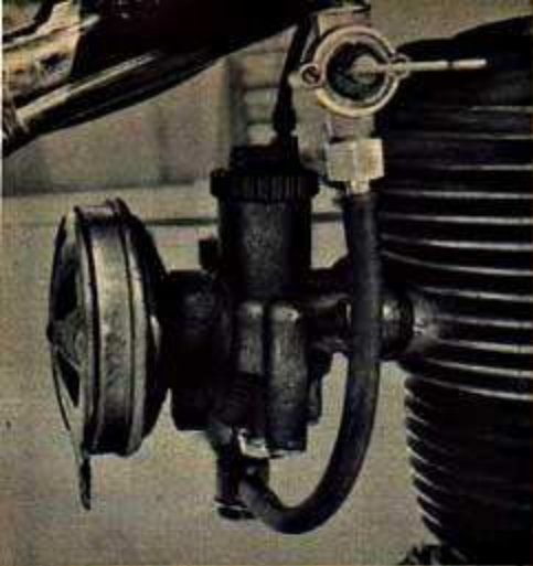
Die alten Blings mit der Hauptdüse in der Verschlusschraube waren bequemer zu reinigen. Die neuen sind auf gutes Funktionieren des Filters angewiesen — über die letzten 6000 km ergab sich kein Düsenedurchblasenmüssen mehr.
