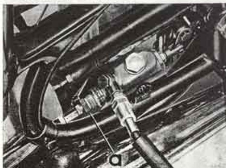
rades kann durch Hineindrehen der Rändelmutter (a) am hydraulischen Bremszylinder verringert bzw. ganz ausgeschaltet werden.
