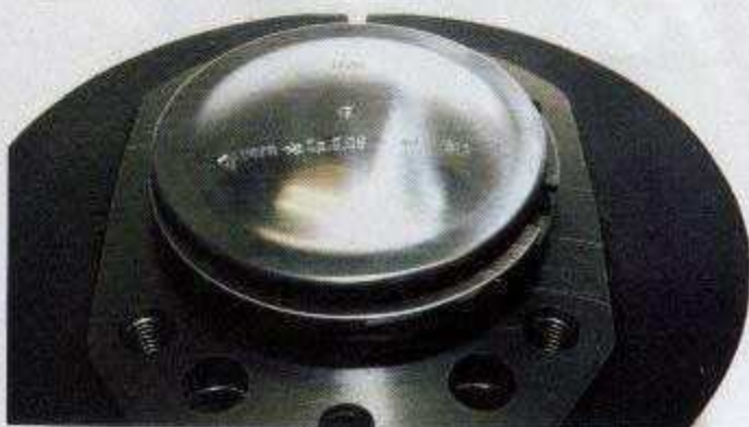
Der Kolben wurde „umgepfelt“, da die Bolzen-Deckslerung beim Automotor der R25 genau entgegengesetzt ist
