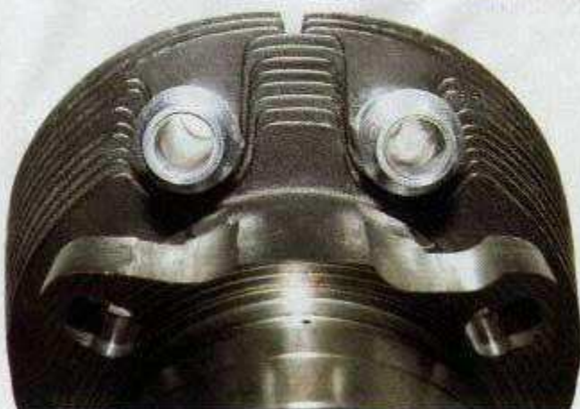
Die großen Ausfräsungen außen am Flansch waren wegen der Stößelführungen erforderlich – der Zylinder läßt sich ja nur senkrecht einführen
