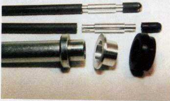
Die Stößelstangen mußten wegen des höheren Zylinders und höherem Totpunkt um 20 mm verlängert werden
